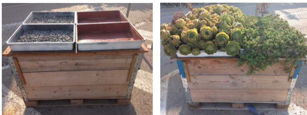
Figura 1: Maqueta de dos compartimentos anexos con cubiertas de referencia: grava (A) y aislante hídrico rojo (B). Maqueta de dos compartimentos anexos con cubierta vegetal: Aeonium arboreum (C) y Aptenia cordifolia (D).
