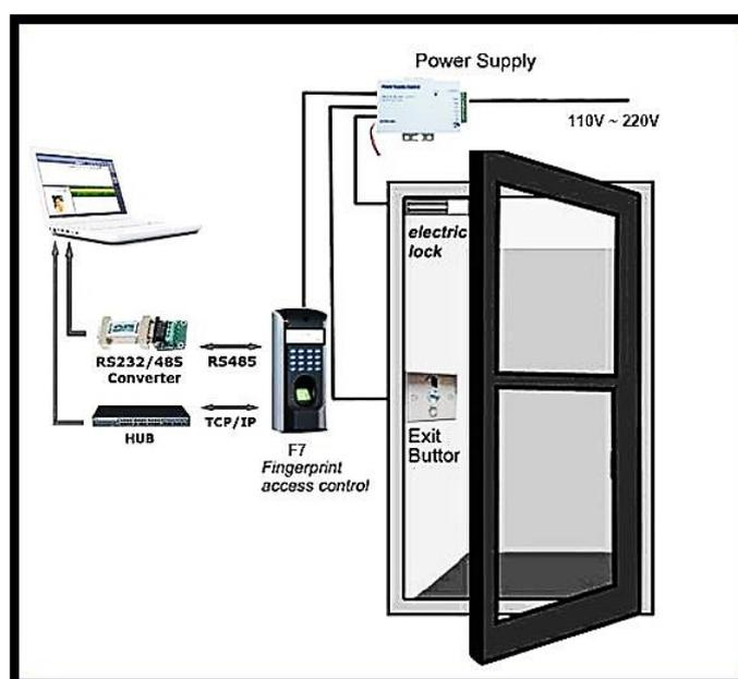
Figura 65. Diagrama de conexión de la Puerta de Acceso
