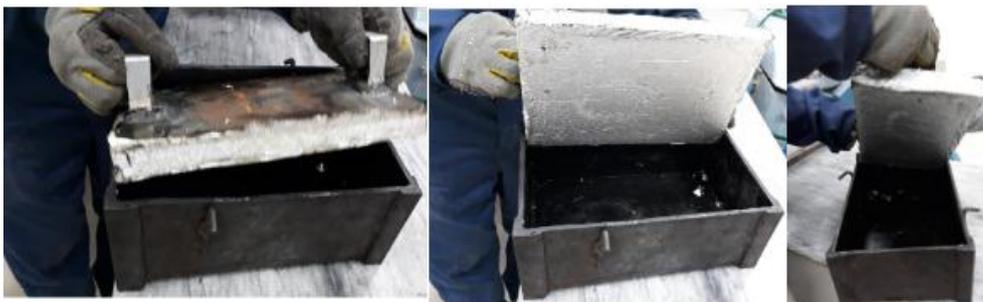
**Figura 28.** Retiro del prototipo del molde
