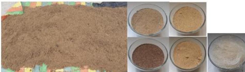
**Figura 22.** Fibras pulverizadas
