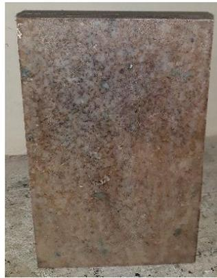
**Figura 10.** Tablero de madera plástica
