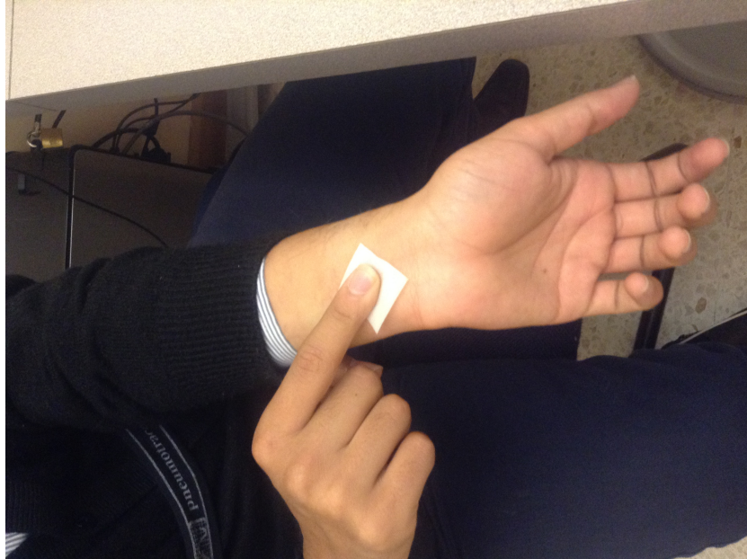
Figura 34. Fotografía de donde se debe limpiar y conectar el GSR (muñeca izquierda y tobillos internos)
