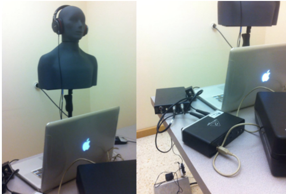
Figura 30. Evidencia fotográfica de la realización de la medición de nivel de presión sonora emitida por los audífonos
