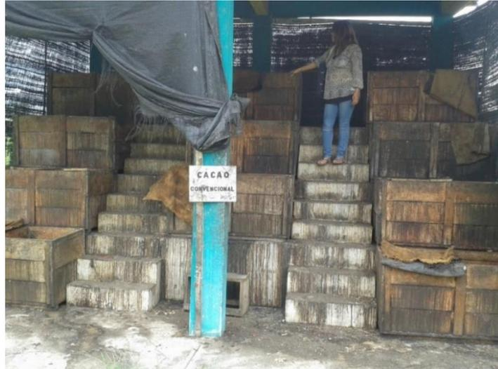
**Figura 7: Cajones de fermentación en disposición escalonada.**
