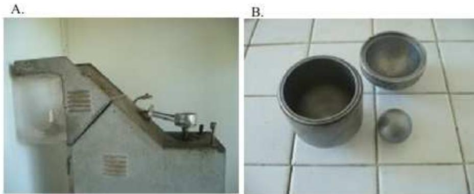
**Figure 17. Système d'extraction mécanique des protéines intracellulaires de *Sa. algeriensis*: A. Broyeur à bille, B. Godet et bille**
