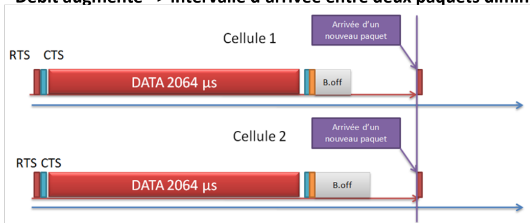
Figure 5.20 : Cycle CSMA/CA et intervalle d'arrivée des paquets
