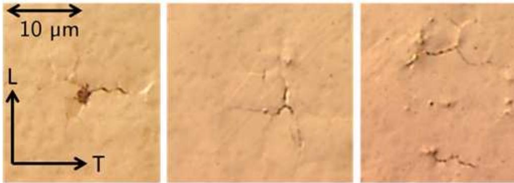
Figure IV.2 : Amorces de fissures observées au microscope optique, pour l'éprouvette A2L1-17 (gauche), A2L1-21 (milieu) et A2L1-26 (droite).
