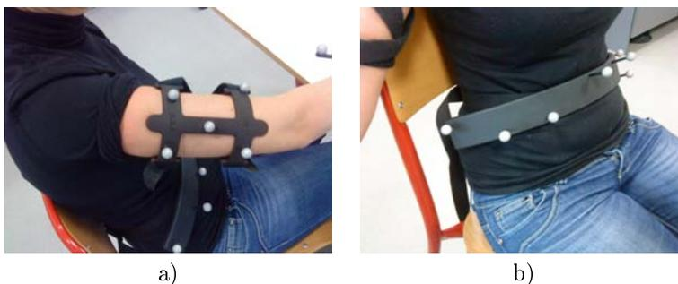
FIGURE 3.5 – Positionnement des marqueurs sur le bras (à gauche) et le buste de chaque sujet (à droite).
