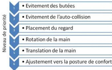
FIGURE 5.32 – Priorité données à l'ensemble des sous-tâches pour un mouvement contraint en position et orientation.
