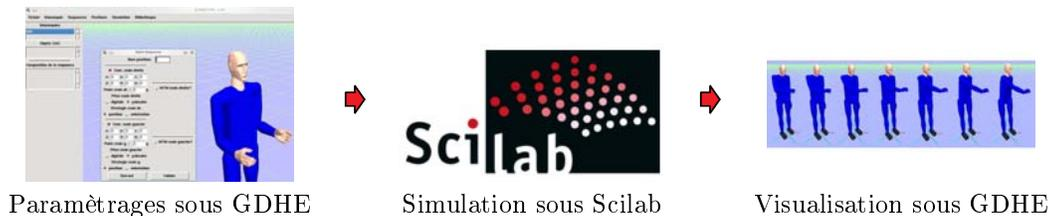
FIGURE 5.2 – Echange de données entre GDHE et Scilab. Le paramétrage du mannequin et de la séquence à jouer s'effectue sous GDHE. Les données sont ensuite transmises à Scilab qui génère à l'aide de notre schéma de contrôle, le mouvement du mannequin. Ce dernier renvoie finalement le geste simulé à GDHE qui peut animer le mannequin.
