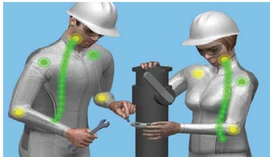
FIGURE 1.25 – Exemple d’analyse posturale via le module Ergonomics Specialists de Delmia [Delmia 13].
