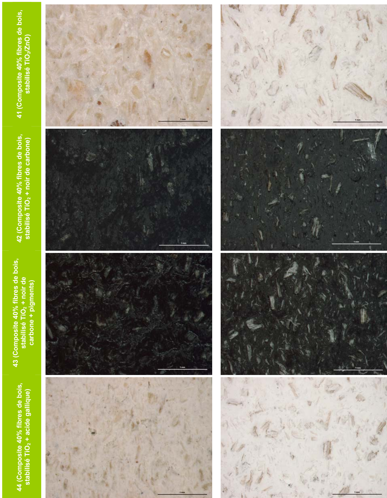
Figure III.6. Micrographies (microscopie optique) de la surface des échantillons présentés au Tableau III.2 avant et après 1500 h de vieillissement climatique accéléré. L'échelle indiquée correspond à 1 mm.
