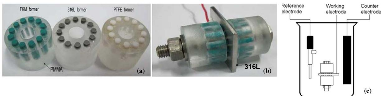
**Figure I-12 :** (a) Photographie des trois assemblages utilisés pour étudier la corrosion caverneuse de l'acier 316L, dont les plots sont constitués de différents matériaux, (b) assemblage de l'électrode de travail, (c) représentation du montage à trois électrodes, d'après Cai *et al.* [Cai10]
