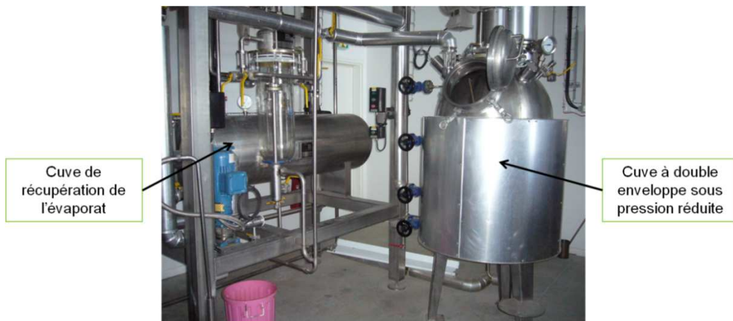
Figure 2.6 Description du dispositif expérimental d'évaporation
