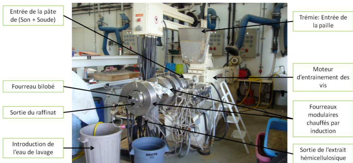
Figure 2.3 Description du dispositif expérimental d'extrusion bi-vis
