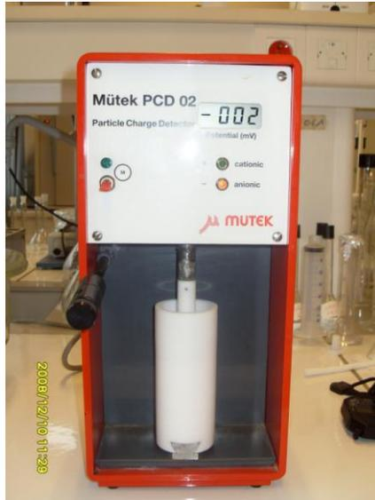
*Figure II-8 : Appareil de mesure du potentiel d'écoulement induit (micro-mütick)*
