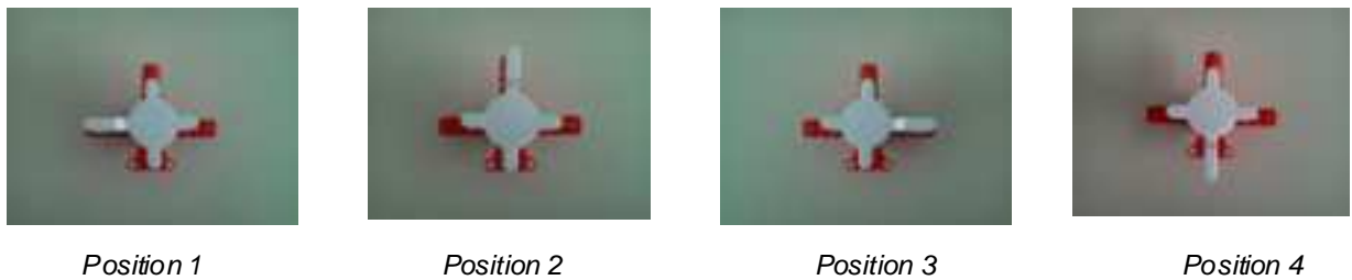
Figure III-8 : Principe d'utilisation des vannes
