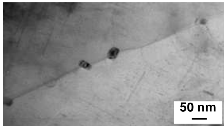
Figure V-28 : Observation au MET d'un joint de grain de l'alliage AA 6101 + e = 20% + 185°C-10h
