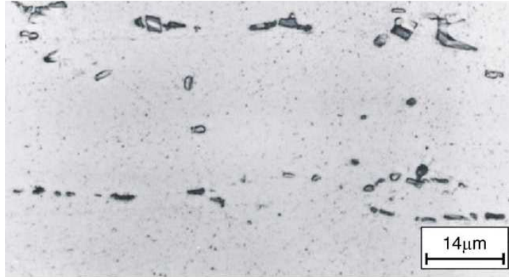
Figure II-13 : Micrographie MEB de la microstructure de l'alliage AA 6005 après filage à chaud [31]
