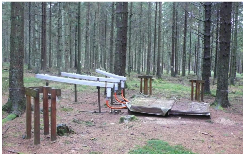
Figure I-15. Gouttières pour la collecte des pluiolessivats : trois gouttières en PVC disposées en épis sont connectées à un même bidon de 10 L, placé dans une fosse (Gandois, 2009)
