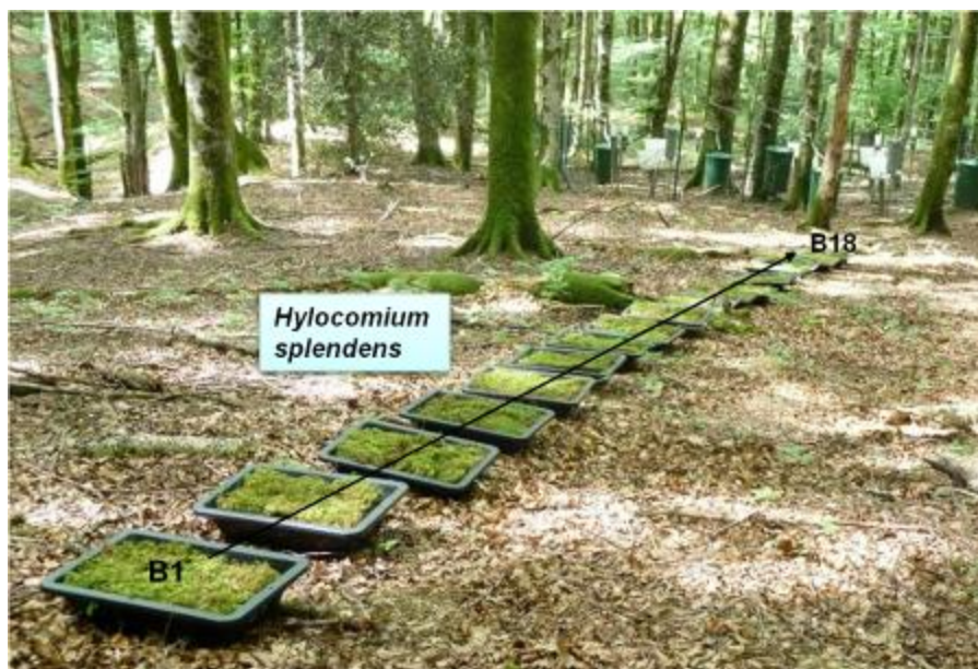
Figure IV-14. Biosurveillance active sous couvert forestier des retombées atmosphériques de HAP
