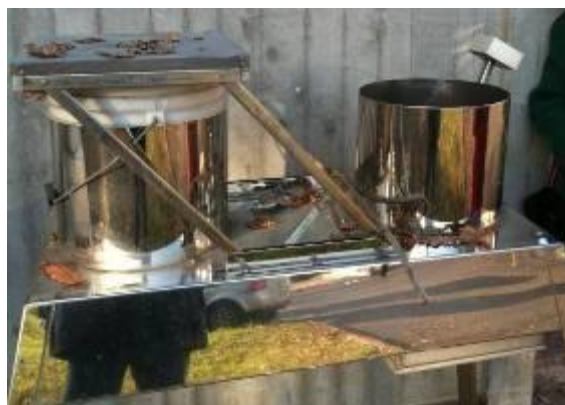
Figure I-12. Collecteur de dépôts secs et humides utilisé à l'Agence Nationale du Conseil Supérieur des Recherches Scientifiques d'Espagne
