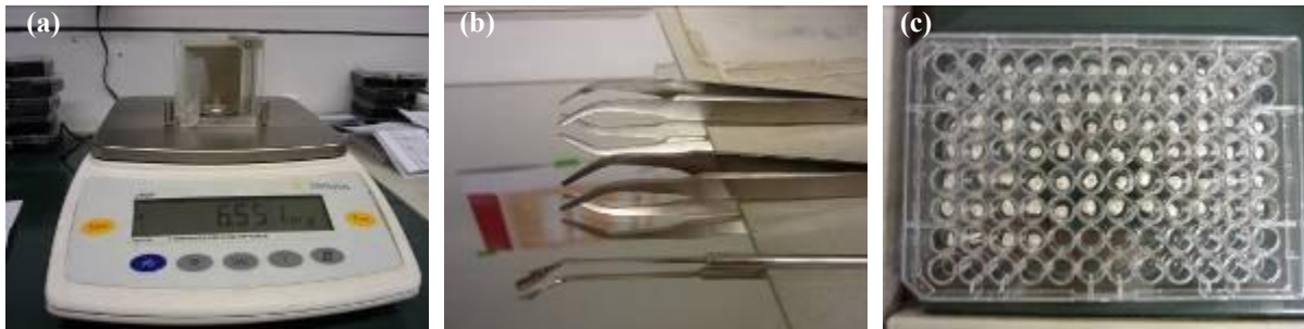
Figure V-16. (a) Balance micrométrique utilisée pour peser les nacelles d'échantillon, (b) Matériel utilisé pour préparer les nacelles : miroir, pincettes et spatule en acier inoxydable, (c) Plaquette contenant les échantillons pour prêts pour l'analyse
