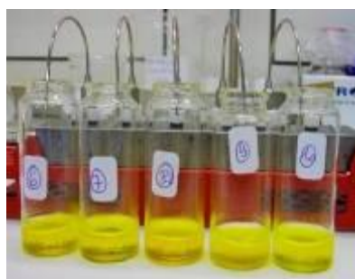
Figure II-9. Concentration des extraits purifiés sous courant d'azote
