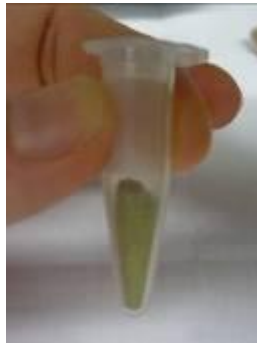
Figure V-15. Echantillon de mousse Hypnum cupressiforme lyophilisé et broyé ( \phi < 50 \mu\text{m} ) destiné à l'analyse élémentaire et isotopique du carbone et de l'azote
