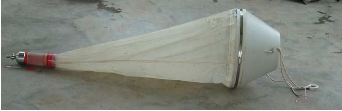
Photographie 4. Filet à plancton utilisé pour le prélèvement des algues pélagiques.
