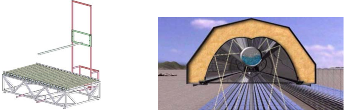
FIGURE 3.6 – A gauche : Vue CAO du prototype en construction au laboratoire Rapsodee ; à droite : image d'un CPC - Récepteur des collecteurs NOVATEC-BIOSOL
