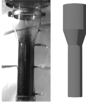
FIGURE 3.9 – Comparaison entre la maquette expérimentale transparente [8] et la géométrie modélisée
