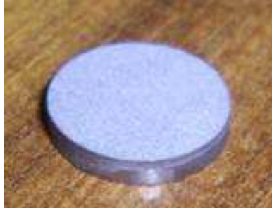
Figure 3.4 : Photographie d'un échantillon de titane revêtu d'hydroxyapatite par mini-torche plasma
