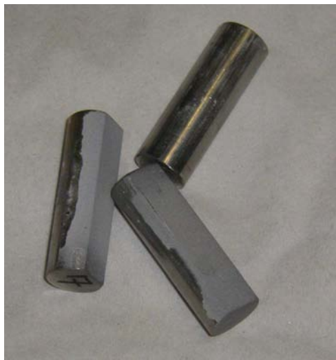
Figure 4.1 : Photographie des revêtements d'HA sur des substrats en acier réalisés par la société 2PS.
