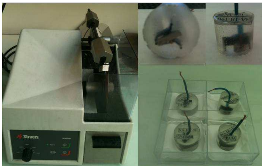
Figure 3.21: Tronçonneuse et coupes transverses des échantillons étudiés
