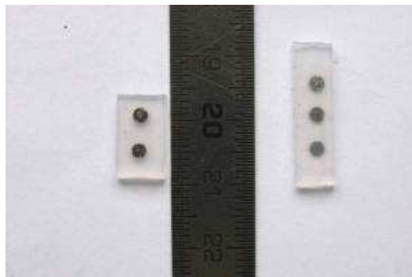
Figure III-29 : Bande aimantée moulée dans du silicone
