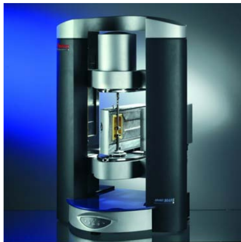
FIGURE 2.24 – Rhéomètre Haake Mars utilisé pour les mesures rhéologiques isothermes et dynamiques
