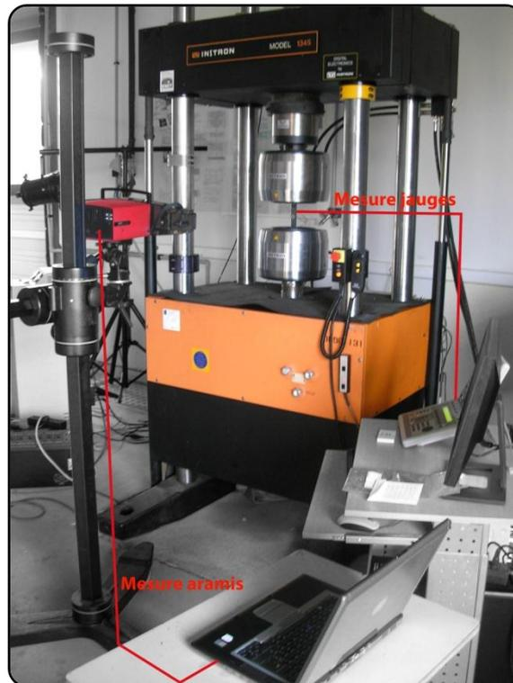
Figure 1-21 : Protocole expérimental de l'essai de traction uniaxiale avec mesures de déformations
