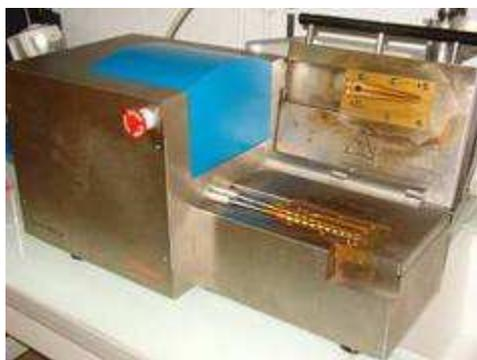
**Photographie 5- 3 : Rheomètre Haake MiniLab (à gauche) et détail du canal de recirculation (à droite)**
