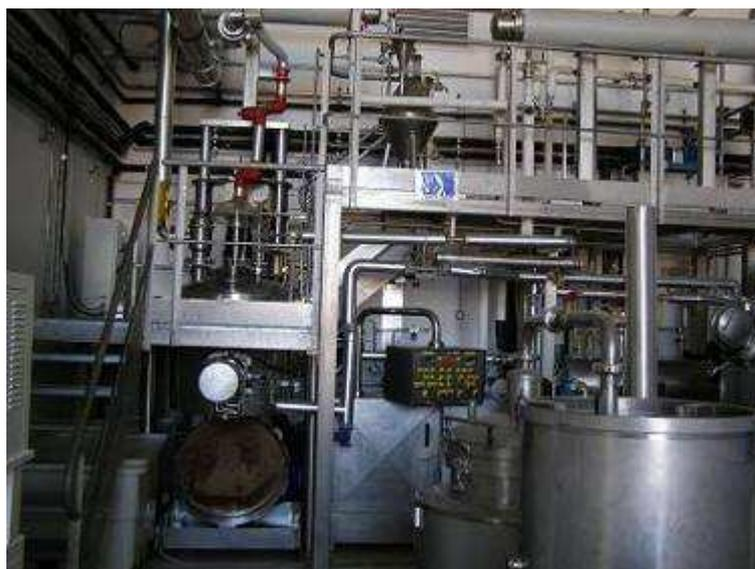
**Photographie 4- 1 : Extracteur Tournaire d'une capacité de 300 litres**
