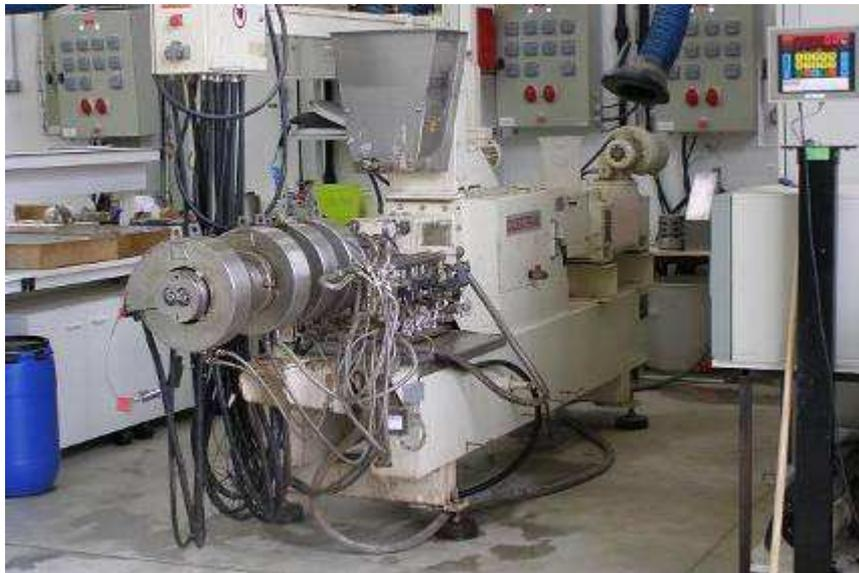
Figure 5- 2 : L'extrudeuse Cleextral BC45
