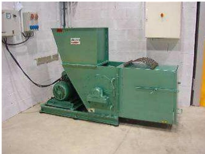
**Photographie 3- 3 : Broyeur à marteaux Electra Goulu**
