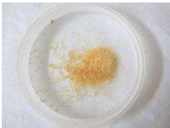
Photographie 4- 12 : Colle d'os obtenue à partir d'un extrait à pH alcalin du GPM
