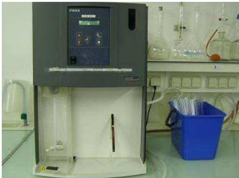
**Photographie 5- 1 : Appareil Tecator Kjeltac 2200**
