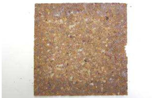
Photographie 4- 13 : Plaque épaisse obtenue par thermopressage du GPM (P=260 bars, t= 1 min, T=150 °C, granulométrie comprise entre 2,5 et 5 mm)
