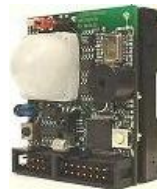
Figure I.5 Nœud capteur de la plate-forme ScatterWeb.
