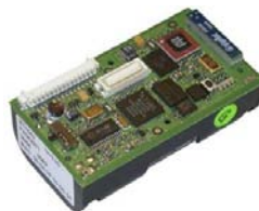
Figure I.6 Nœud capteur BTnode.
