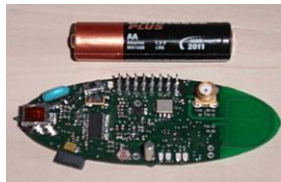
Figure I.4 Nœud capteur du projet EYES.
