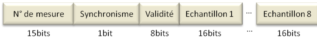
Figure II.16 Message applicatif de relevé de mesure.
