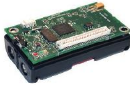
Figure I.3 Nœud capteur Mica2 Mote.
