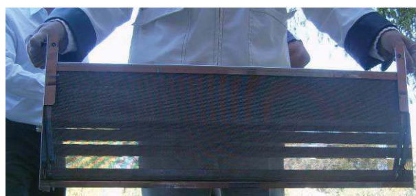
Figure II-30. Elément du dégrilleur du site 2
