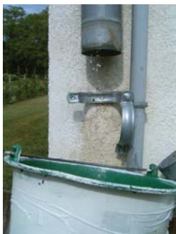
Figure II-42. Prélèvement d'eaux de ruissellement de toiture sur le site 1
