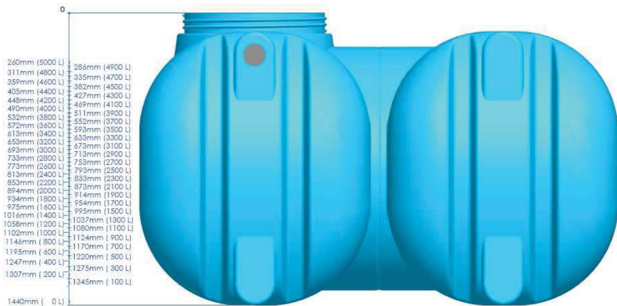
Figure V-9. Tableau de jaugeage de la cuve de 5 m 3 sur le site 1
