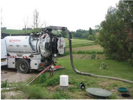
Figure II-20. Camion hydrocureur sur le site 1 Figure II-21. Prélèvements d'eaux chargées en sédiments sur le site 1
