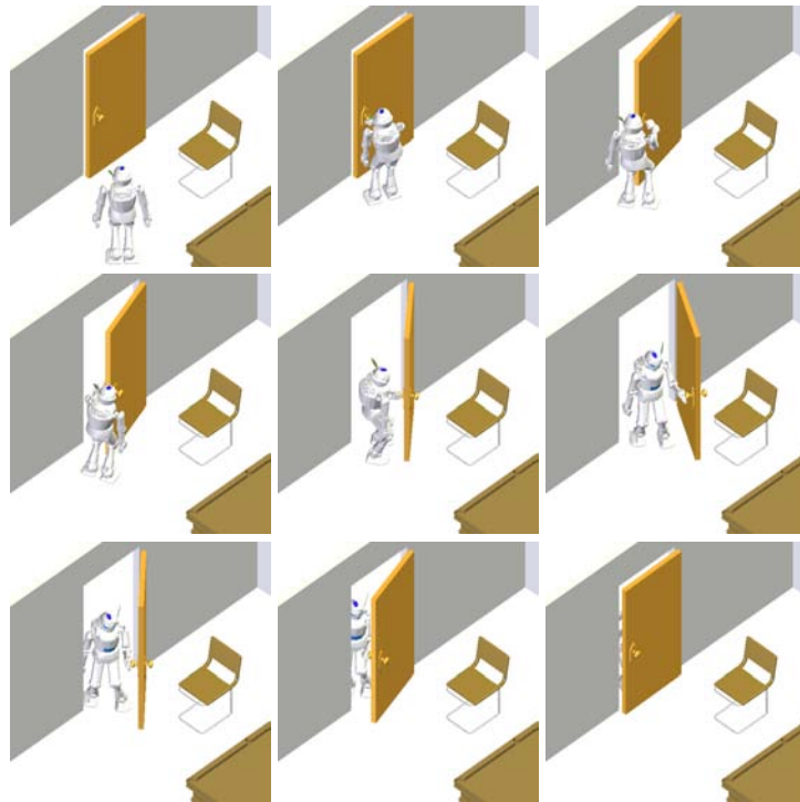
Figure 7.6 – Trajectoire de marche à l'équilibre dynamique pour le robot Partner qui passe une porte. Une chaise rend le problème de planification plus difficile.
