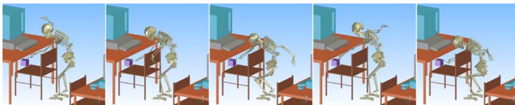
Figure 5.2 – Échantillonnage de sous-variété de \mathcal{CS} . Les contraintes à vérifier sont : les positions des pieds, la position du centre de masse et la position de la main droite. \mathcal{CS} est échantillonné uniformément, chaque échantillon est ensuite projeté sur la sous-variété qui vérifie les contraintes grâce aux outils de cinématique inverse, puis passé au détecteur de collisions.
