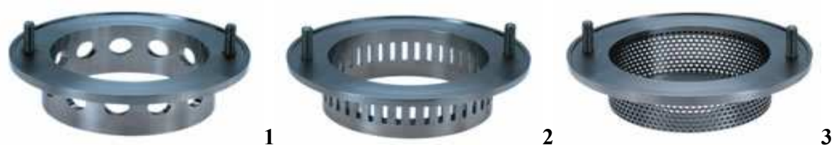
Figure 4 : Différents stators adaptables à la tête de travail du mélangeur rotor/stator : 1. Tête de désintégration polyvalente 2. Tête de désintégration à fentes 3. Grille à trous carrés à haut cisaillement
