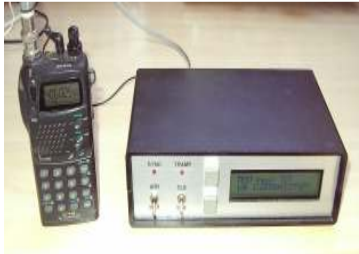
Figure 2.1 : Représentation d'une balise Argos (à gauche) avec un appareil (à droite) identifiant son numéro d'identification.
