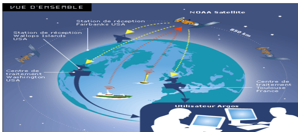
Figure 2.9 : Représentation du système Argos [CLS, 2008].
