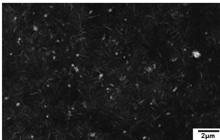
Figure 45. Détails de la couche d'oxyde de l'alliage 625+IndNR formée lors d'une exposition de 500h en milieu primaire REP.
