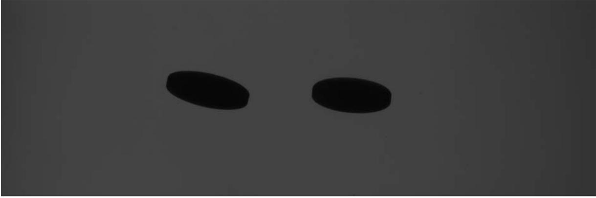
FIGURE 2.3 – Exemple d’image de deux disques identiques chutant côte à côte ( $\chi = 10$ ,  $Re = 255$ ,  $d = 16$  mm,  $U_m = 16,1$  mm.s<sup>-1</sup>).
