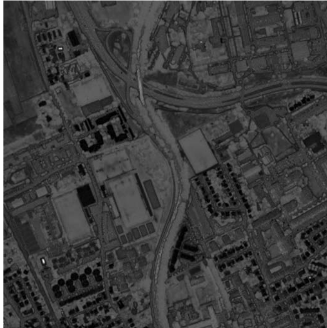
FIGURE 3.19 – Distance spectrale entre l'image 2.1 et la valeur spectrale de référence pour le matériau "tuile"
