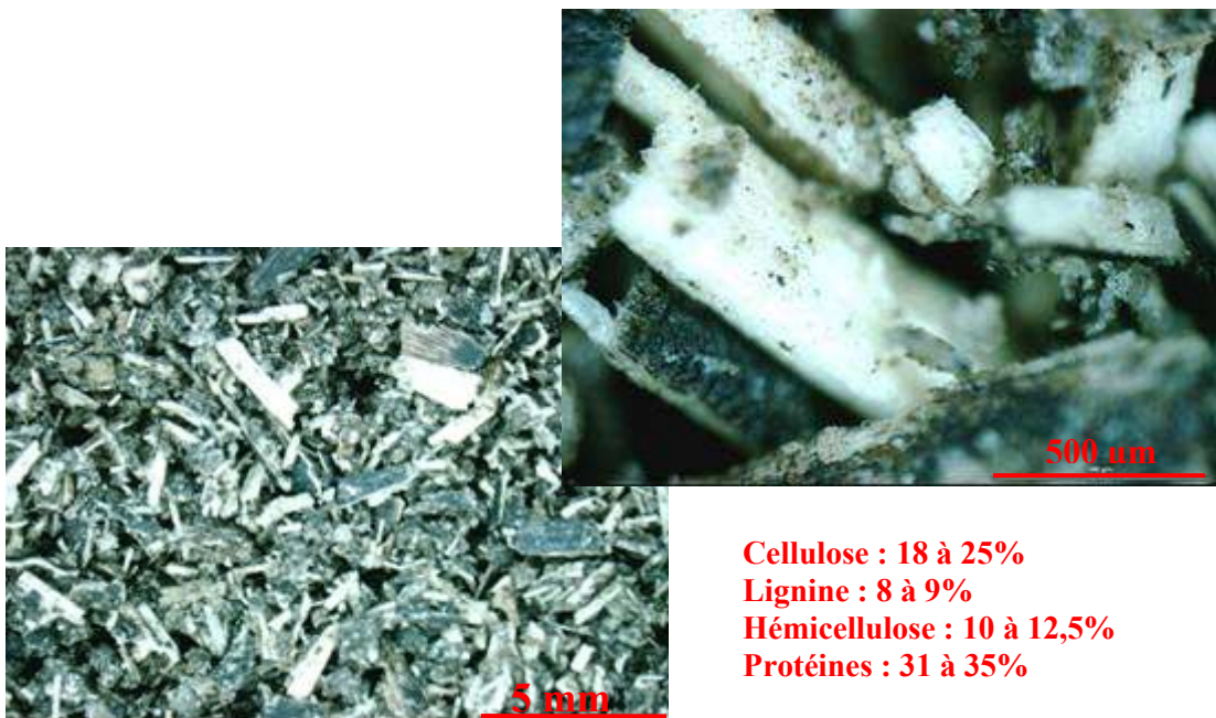
Figure II-1: Observation en microscopie optique du tourteau de tournesol mis en œuvre dans cette étude.
