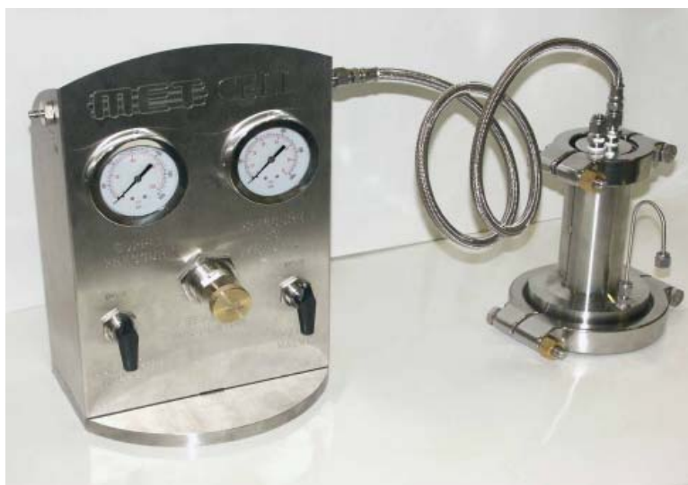
Figure II.6. b) Photo de la cellule avec le régulateur de la pression
