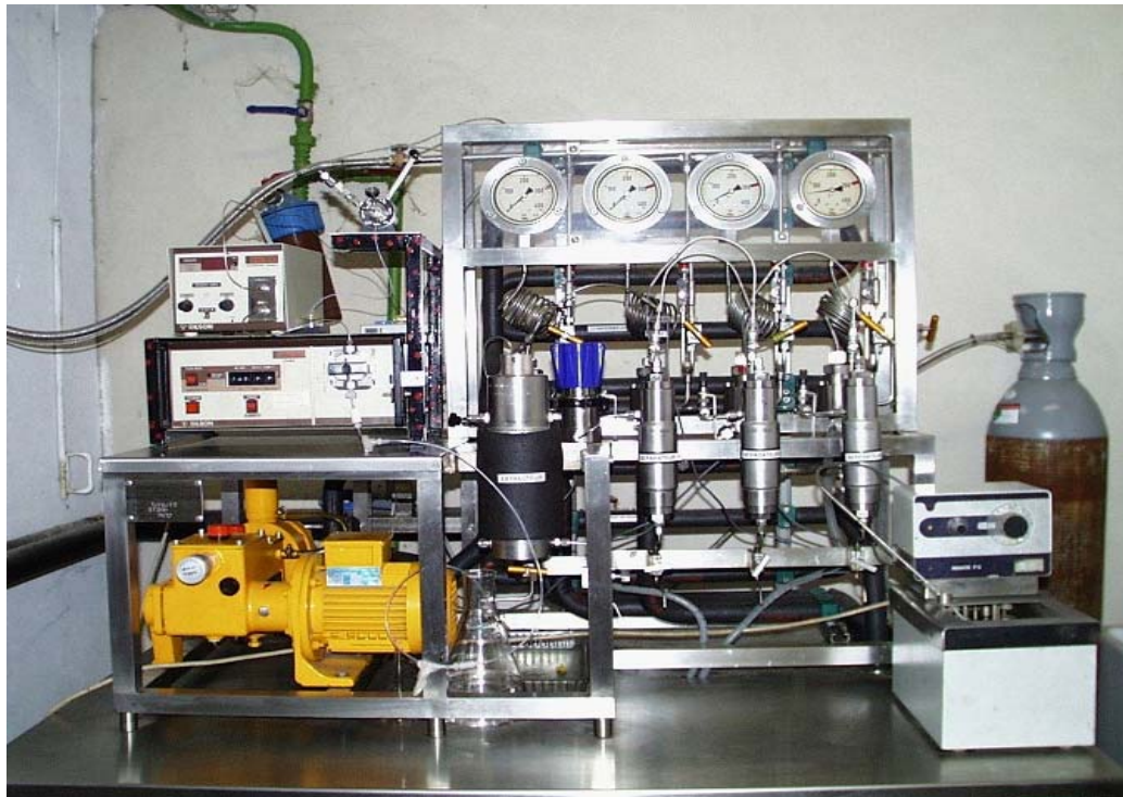
Figure II.2. a) L'installation d'extraction Separex
