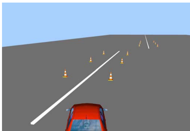
FIG. 6.11 – Rendu 3D d'un passage de VDA avec un essai humain pilotant un modèle SimulinkCar
