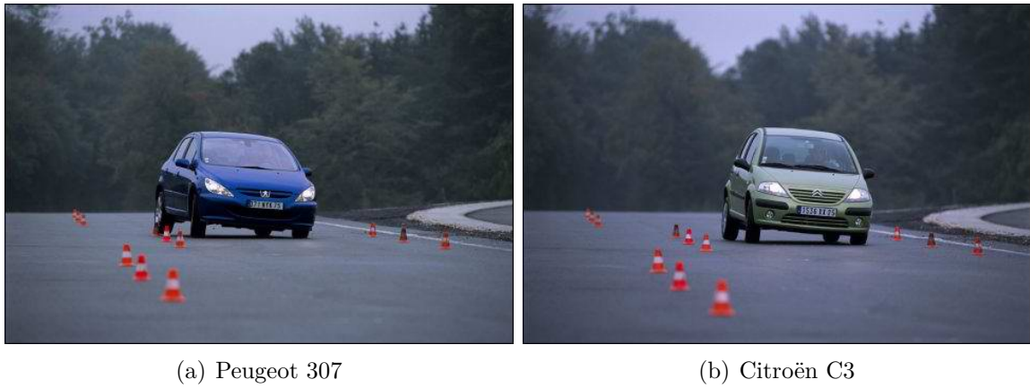
FIG. 2.16 – Les sollicitations dynamiques lors d’un test VDA à 70 km/h sont fortes
