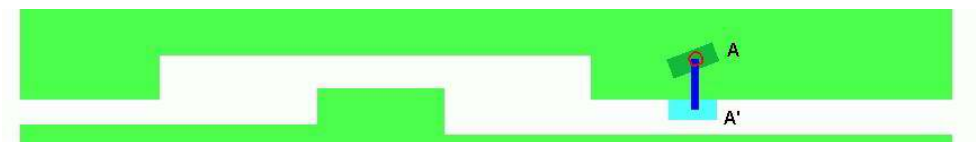
FIG. 4.6 – Utilisation de la distance de pénétration généralisée pour trouver la configuration hors collision la plus proche en termes de translation+rotation
