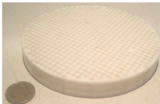
FIGURE 3.4: Photo du support de filtration en Téflon ®
