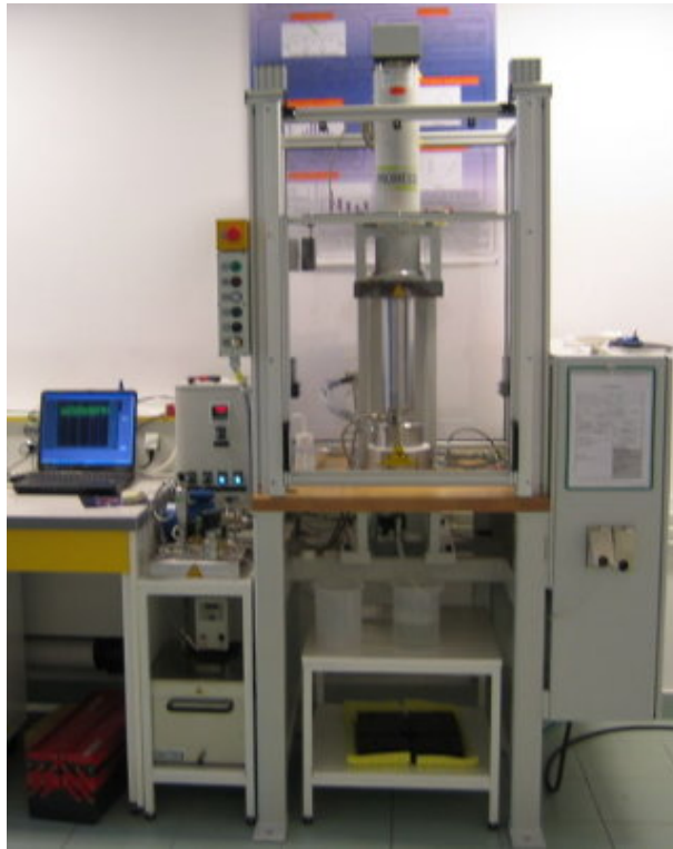
FIGURE 3.7: Installation de la cellule de compression perméabilité
