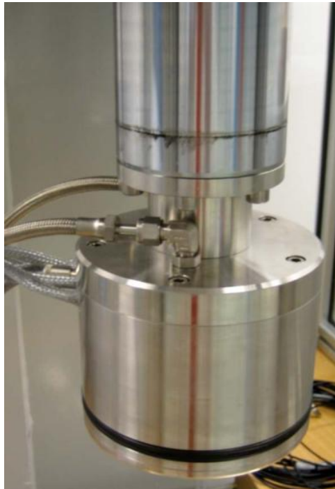
FIGURE 3.6: Photo du piston de la cellule de compression perméabilité. 1 : entrée de l'eau ; 2 : sortie de l'eau ; 3 : capteur de température ; 4 : alimentation des résistances électriques ; 5 : coulisseau de la servopresse ; 6 : surpiston ; 7 : piston ; 8 : joint carré
