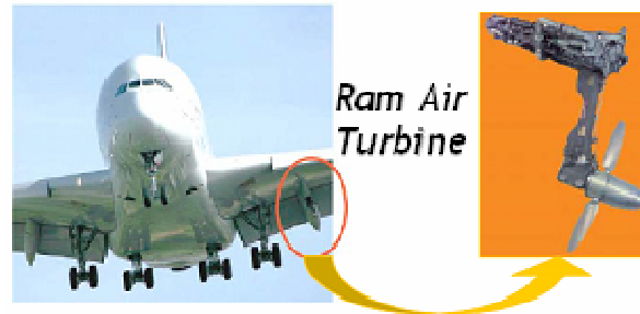
figure I.10 : implantation et photo d'une RAT sur A380
