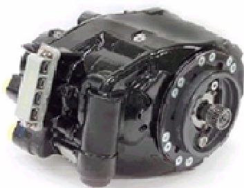
figure I.4 : générateur à fréquence fixe (IDG) placé sur un A340
