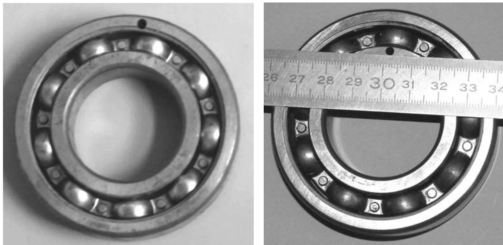
(a) Défaut localisé sur la bague externe (b) Défaut localisé sur la bague interne
