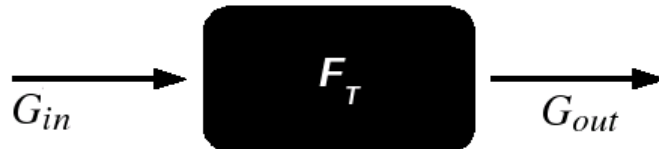
FIG. 2.1 – Modélisation de la zone d'intérêt par une boîte noire de fonction de transfert F_T .
