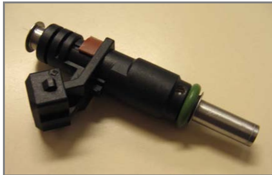
Figure 6: Photographie de l'injecteur liquide pulsé utilisé dans le bâti de photo-CVD
