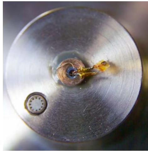
Figure IV.13 Photo du support porte échantillon avec capteurs de température, de pression et le chauffeur
