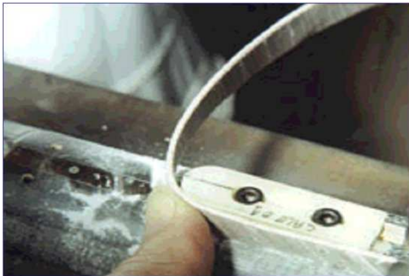
Figure I.10. Tests de bobinage avec un câble Nb_3Sn non réagit enrubanné avec un ruban d'imprégnation (Puigsegur 2004).
