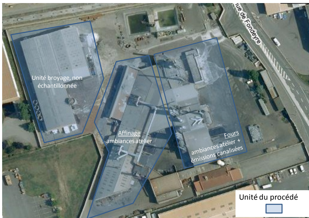
Figure 10 : Schéma localisant les trois sources de particules échantillonnées
