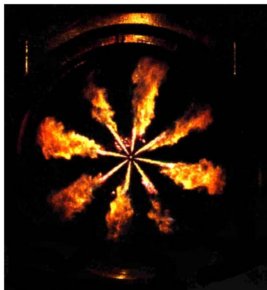
(b) Visualisation de la combustion dans un moteur Diesel injection directe multi-trous
