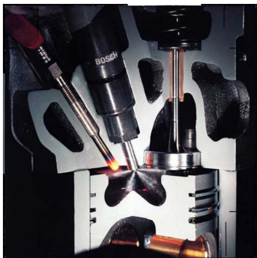
(a) Vue éclatée de la chambre de combustion d'un moteur Diesel injection directe multi-trous
