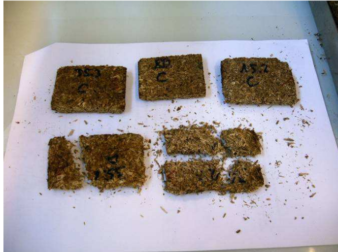
Photo 4.1 : Gonflement en épaisseur de panneaux de particules à matrice de poudres d'organes bruts de plantes après 2 heures d'immersion.
