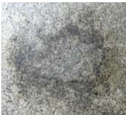
Photo 3.5 : Cloques au centre de panneaux de particules de tige de kénaf et de résine U.F.
