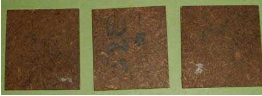
Photo 4.2 : Eprouvettes de panneaux de particules de tige de k naf et poudre de cosse de P. biglobosa extrud es
