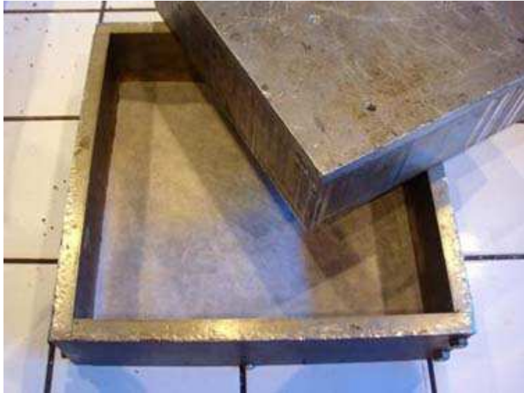
Photo 3.3 : Moule mis en œuvre pour l'étude du thermopressage
