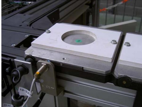
Figure IV.14 : photo de l'entrée d'un poste de travail avec au premier plan le détecteur (à droite) et la tête de lecture/écriture (TLE)
