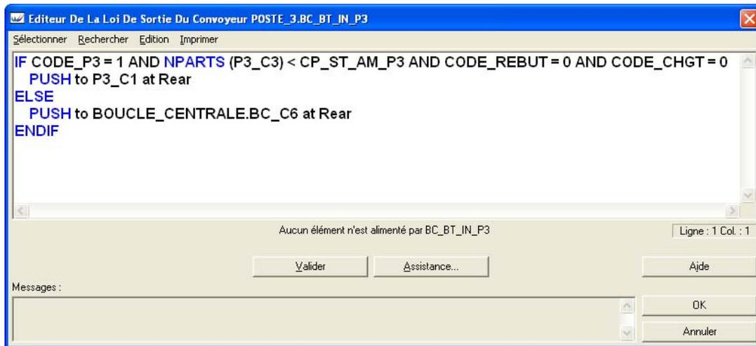
Figure IV.16 : modélisation de la règle d'accès d'une palette sur un poste de travail
