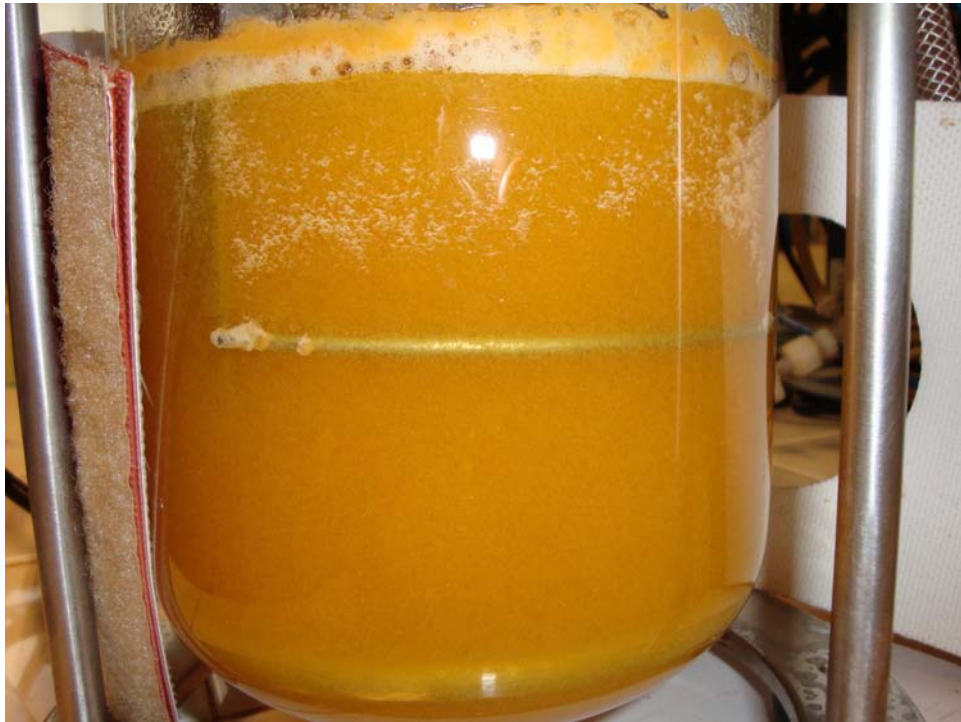
Figure II.4 : Illustration du phénomène d'adhésion des pelotes sur la paroi du réacteur. Sa. algeriensis , culture « batch » en réacteur, 30°C pH initial 7, 250 rpm.
