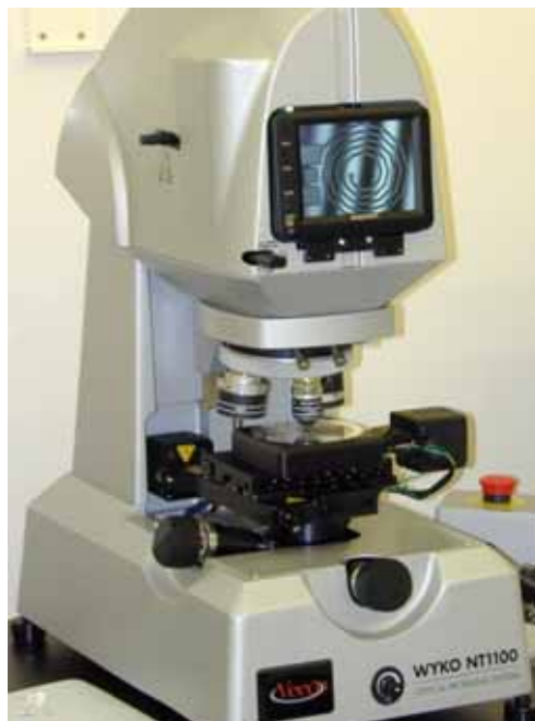
Figure 94 – Profilomètre Optique Veeco Wyko NT1100
