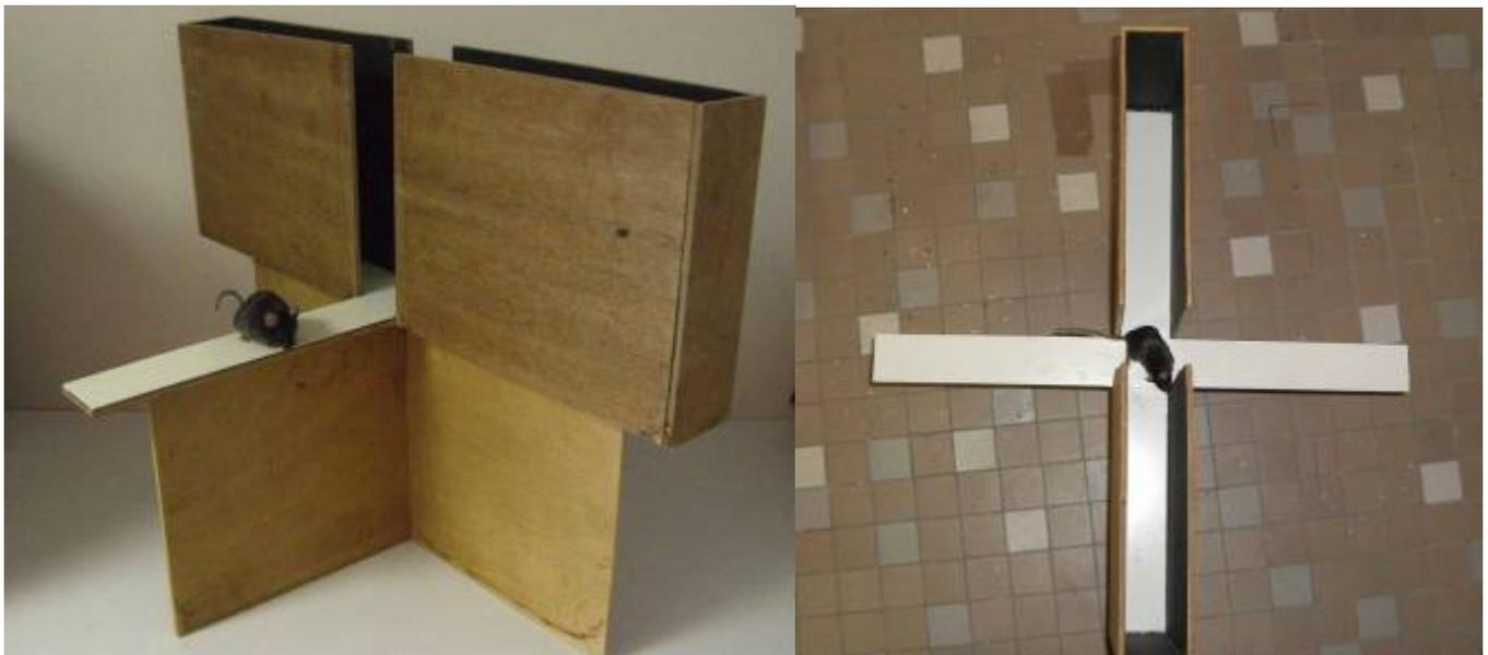
**Figure III.3 :** *Labyrinthe en croix surélevé, vue de profil (à gauche) et vue de dessus (à droite).* Le dispositif présente deux branches fermées par des parois en bois et deux branches ouvertes, l'ensemble, vue de dessus, représentant une croix. Le tout est positionné en hauteur, à environ 22 cm au dessus du sol.
