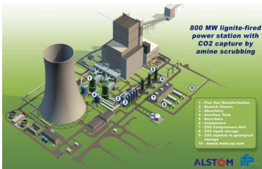
**Figure 1.2-** Exemple d'une centrale électrique muni du procédé de captage de CO<sub>2</sub>
