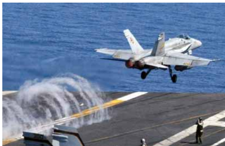
Figure 1.3 Visualisation du sillage d'un avion militaire F-18 Hornet décollant d'une porte-avion
