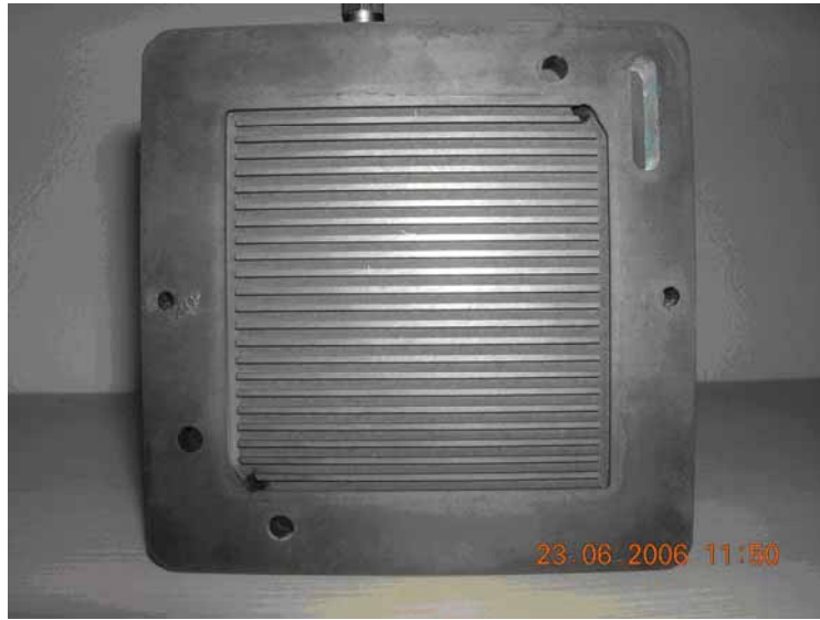
Figure II-12: Exemple de canaux en Z – Cellule ELECTROCHEM présente au LAPLACE
