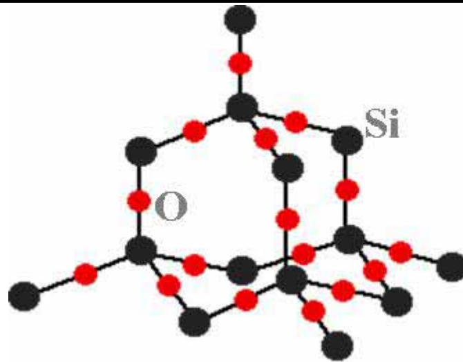
Figure 4. 30 : Maille cristalline de la silice.
